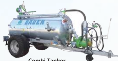
Combi Tanker เครื่องฉีดปุ๋ยน้ำประเภทถังเหล็ก ขนาดตั้งแต่ 2,600 - 10,700 ลิตร
