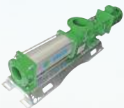
Helix Pump สกรูปั๊มส่งกากตะกอนในแนวราบ -มอเตอร์ 5.5 - 11 kW -อัตราการไหลสูงสุด 65 m 3 /hr -กำลังส่งสูงสุด 60 m
