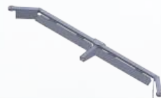
ความกว้างตั้งแต่ 2.5 - 4 เมตร ใช้มอเตอร์ขนาด 1.5 - 2 kW ในการขับเคลื่อน ใช้ใช้ในการลาก สามารถทำงานได้ตลอด 24 ชั่วโมง
